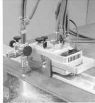
IMP für automatische Geradeschnitte durch Laufbahnführung
