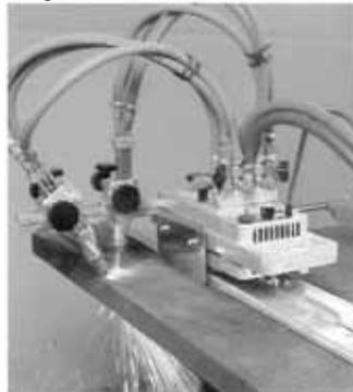
IMP mit Kreisschneideinrichtung für automatische Kreisschnitte
