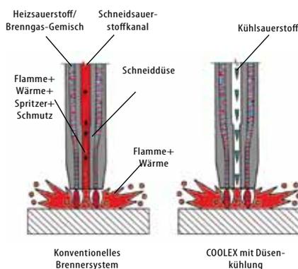
Bereits während des Vorwärmens strömt wenig Sauerstoff aus dem Heizsauerstoffkanal über ein Kühlsromventil in den Schneidkanal und bewirkt eine effiziente, innere Kühlung der Düsen. An kühleren Düsen können sich keine Schneidspritzer mehr festsetzen, die empfindlichen Auslaufkanäle werden nicht mehr beschädigt. Die Folge: die Düsenstandzeiten verlängern sich.
