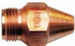
Handbrennschneiddüse für einfache Trennzwecke. Für Acetylen Injektor-Handschneidbrenner und Schneideinsätze, Schneid- und Heizdüse unverchromt. Schneiddüse R Einschraubgewinde M 8, Heizdüse R Einschraubgewinde M 21 x 1,5.
