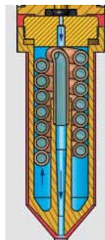
Der Heizsauerstoff wird durch eine Kupferspirale geführt. Damit gelangt bei einer eventuellen Rückzündung Heizsauerstoff nur verzögert in die Mischdüse und schützt so den Brenner vor Zerstörung!
