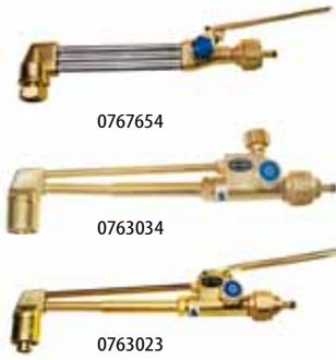
Federhebel – Handrad. 2 Rohre = Injektor (double safety Injektor) 3 Rohre = Gasemischend, Schneidbereich 3 – 100 mm
